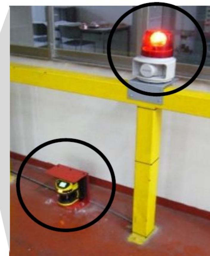
新設したセンサーとブザー付きパトランプ
